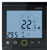
Термостат управляет термоэлектрическим приводом системы водяного поверхностного отопления по показаниям встроенного датчика температуры окружающего воздуха или по входящему в комплект, внешнего датчика.
